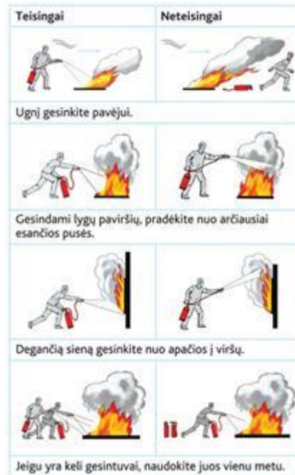
2 pav. Gaisro gesinimo gesintuvų schema
