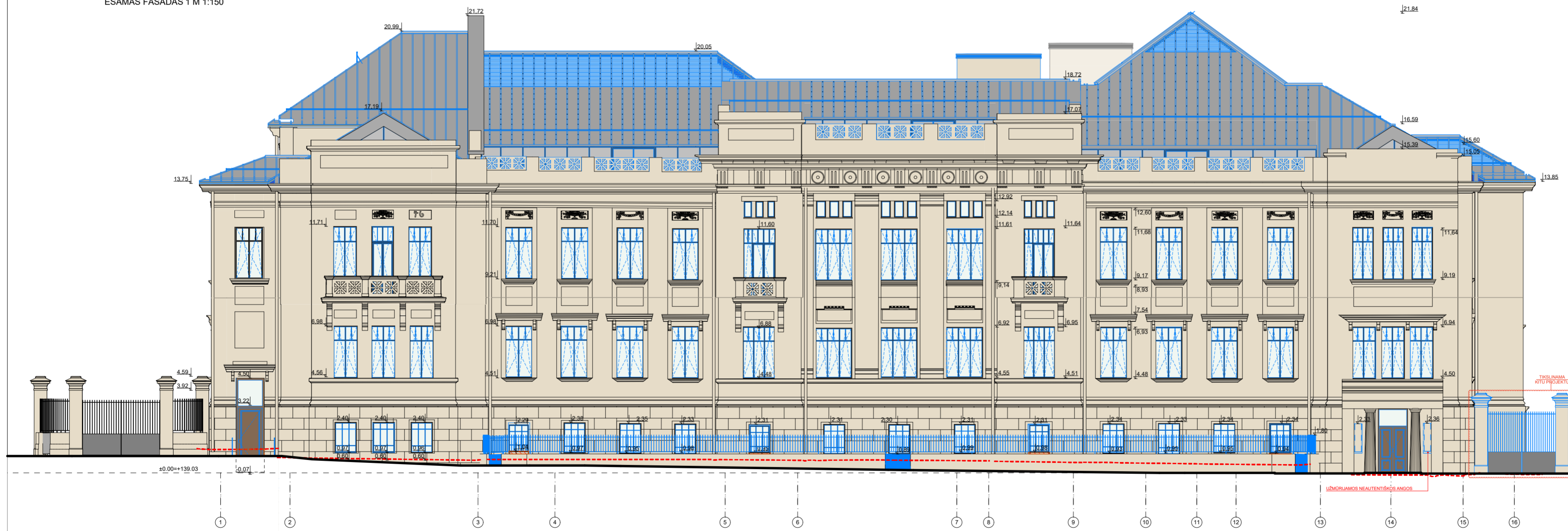
PROJEKTUOJAMAS FASADAS TARP AŠIŲ 1-15 M 1:150
