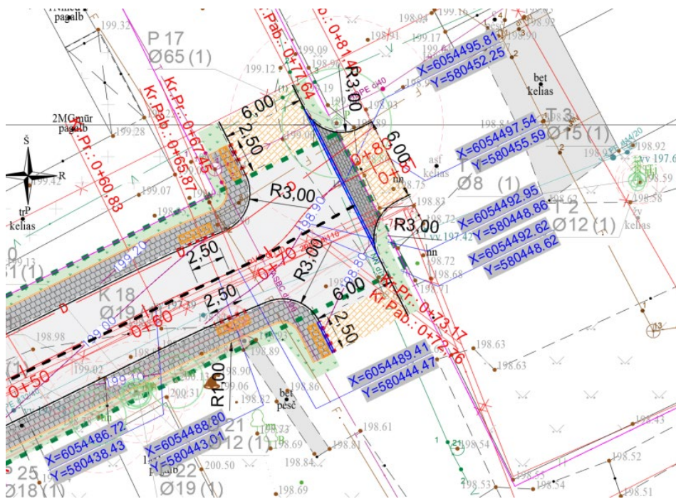
Pav. 7. Sankryžos ties Mechanikų g. 93 sklypu projekto sprendiniai (projekto brėžinio fragmentas).
