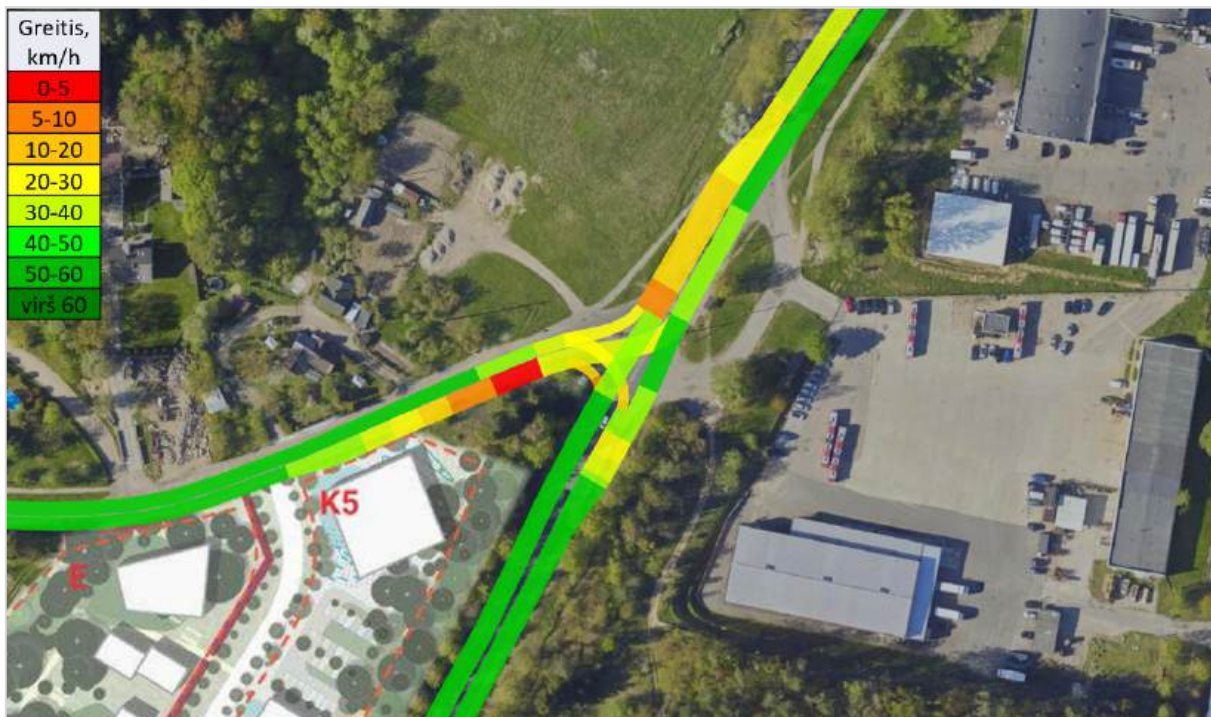
46 pav. Vidutinis automobilių greitis sankryžoje Nr. 1, vakarinis pikas Projektinis variantas Nr. 2 – šviesoforinė sankryža
