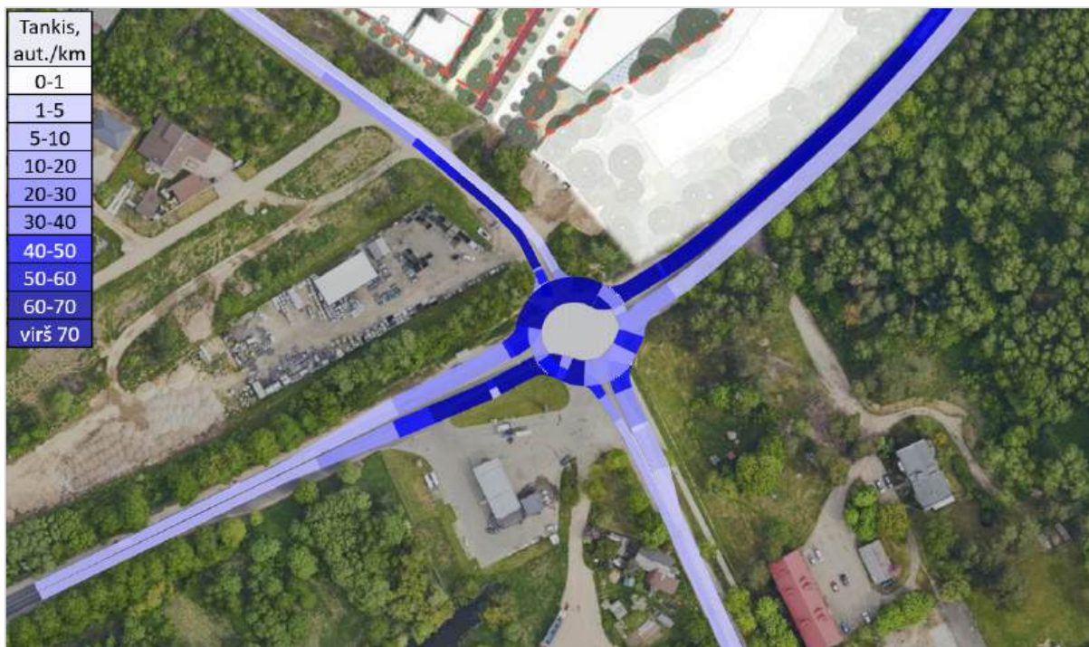
71 pav. Transporto priemonių tankis sankryžoje Nr. 3, vakarinis pikas Projektinis variantas Nr. 1 – žiedinė sankryža
