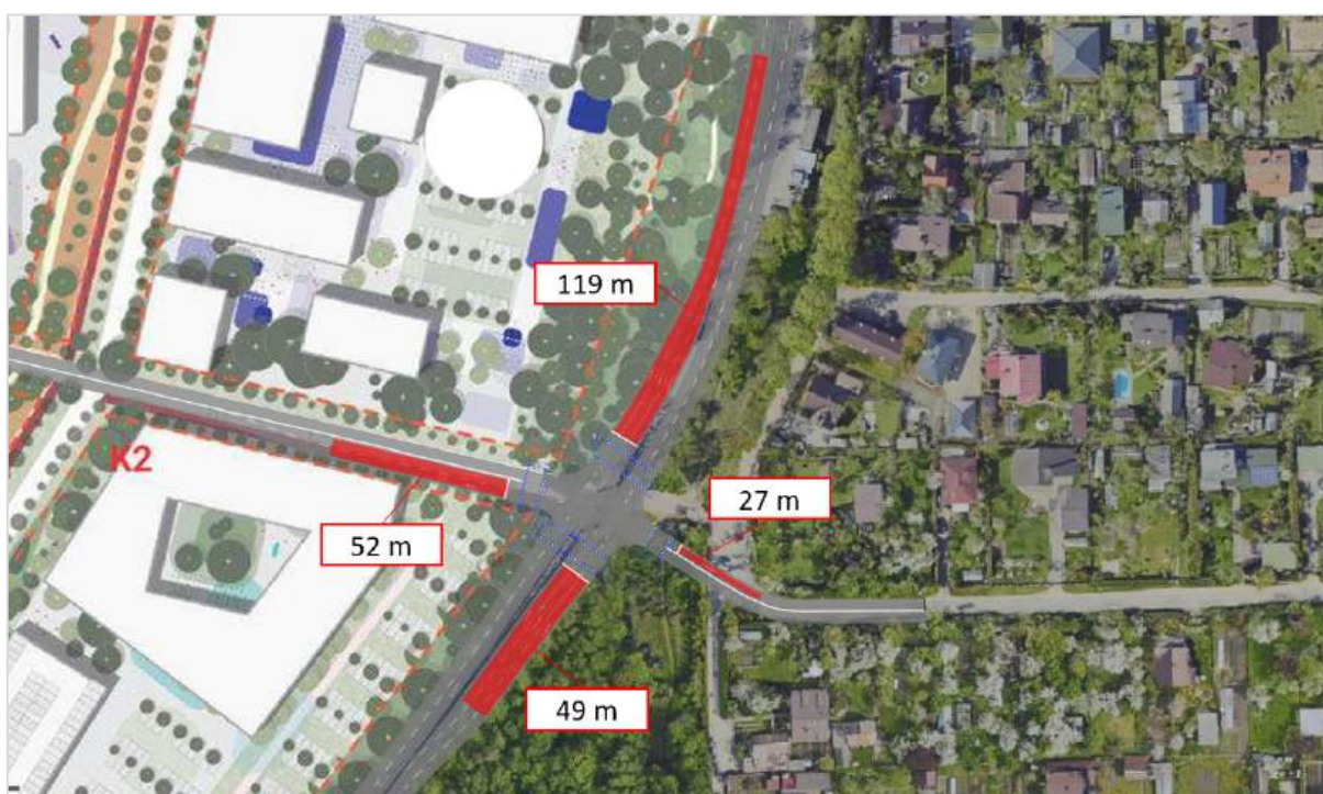
64 pav. Vidutiniai momentinių maksimalių eilių ilgiai sankryžoje Nr. 2, vakarinis pikas Projektinis variantas Nr. 2 – šviesoforinė sankryža
