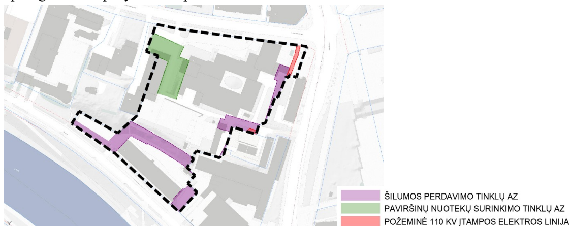
4 pav. Magistralinių tinklų apsaugos zonų schema
