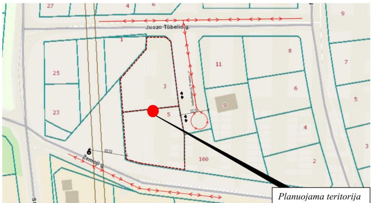
5 pav. Situacijos schema nuo planuojamų sklypų iki hidranto ir gaisrinių automobilių judėjimo trajektorija
