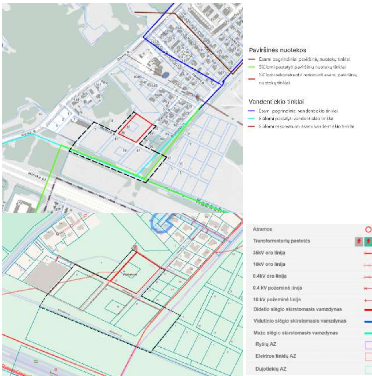
13, 14 pav. Nagrinėjamos teritorijos inžinerinės infrastruktūros schemos
