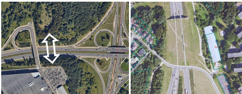
31 pav. Siūloma estakados tipo žalioji jungtis prie PC „Akropolis“ ir esama „žalioji estakada“ ties Gudeliais
