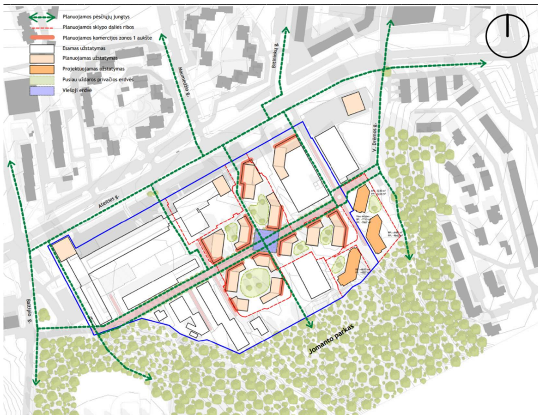
4.4.2 pav. Teritorijos erdvinės struktūros architektūrinis formavimas. Antroji teritorijos vystymo koncepcijos alternatyva. Antrojoje alternatyvoje išlaikoma Jeruzalės mikrorajono užstatymo orientacija. Pėsčiųjų ir susisiekimo ašių susikirtime formuojama rombo formos aikštė.
