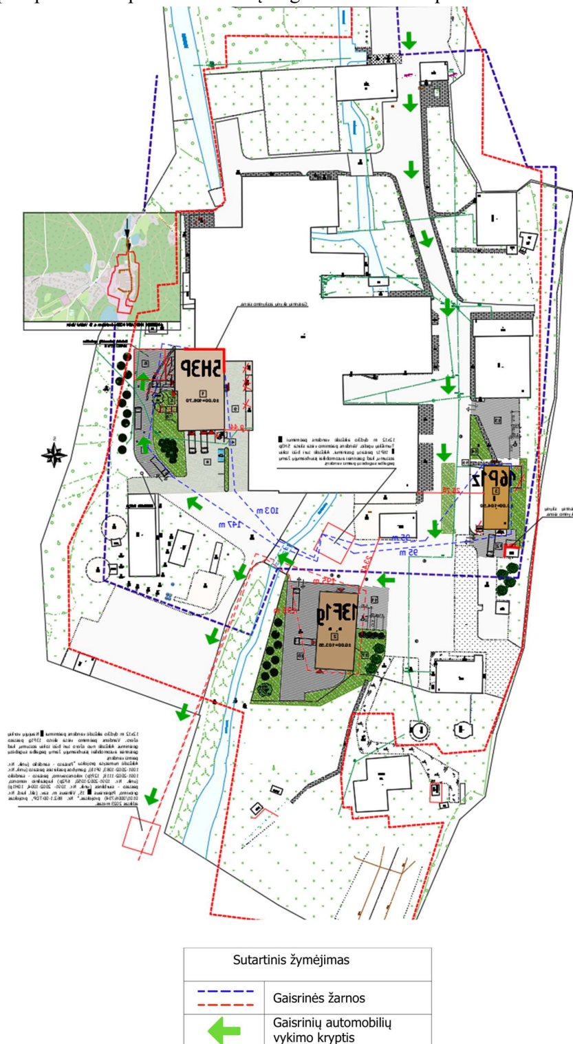
14. pav. Gaisrų gesinimo ir gelbėjimo automobilių įvažiavimo į sklypą, privažiavimo prie statinių ir apsisukimo (jei reikia) aikštelės
