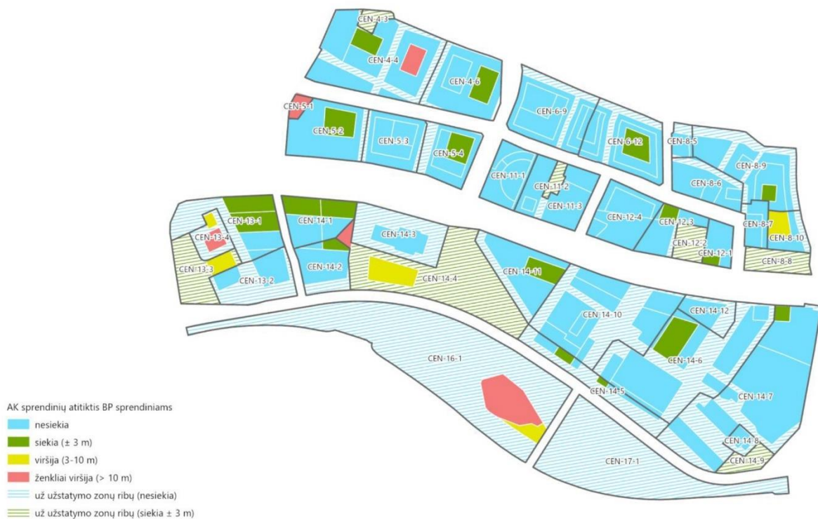
1.7 pav. Nustatytų „Architektūrinės kalvos“ formavimo parametrų ir galiojančio bendrojo plano sprendinių atitiktis
