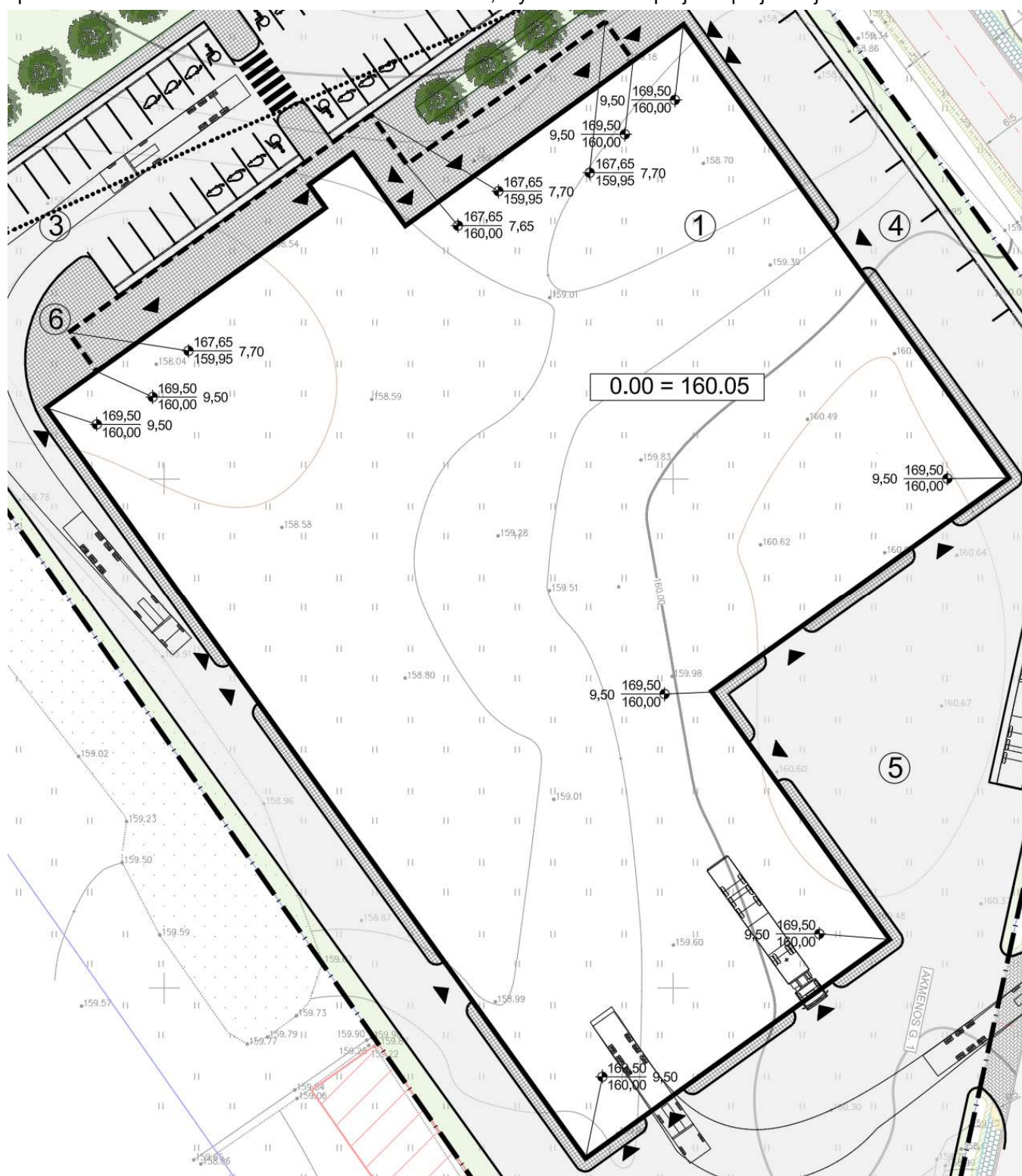
4. pav. Projektuojamo pastato kontūro kampai su projektuojamomis žemės paviršiaus altitudėmis.
