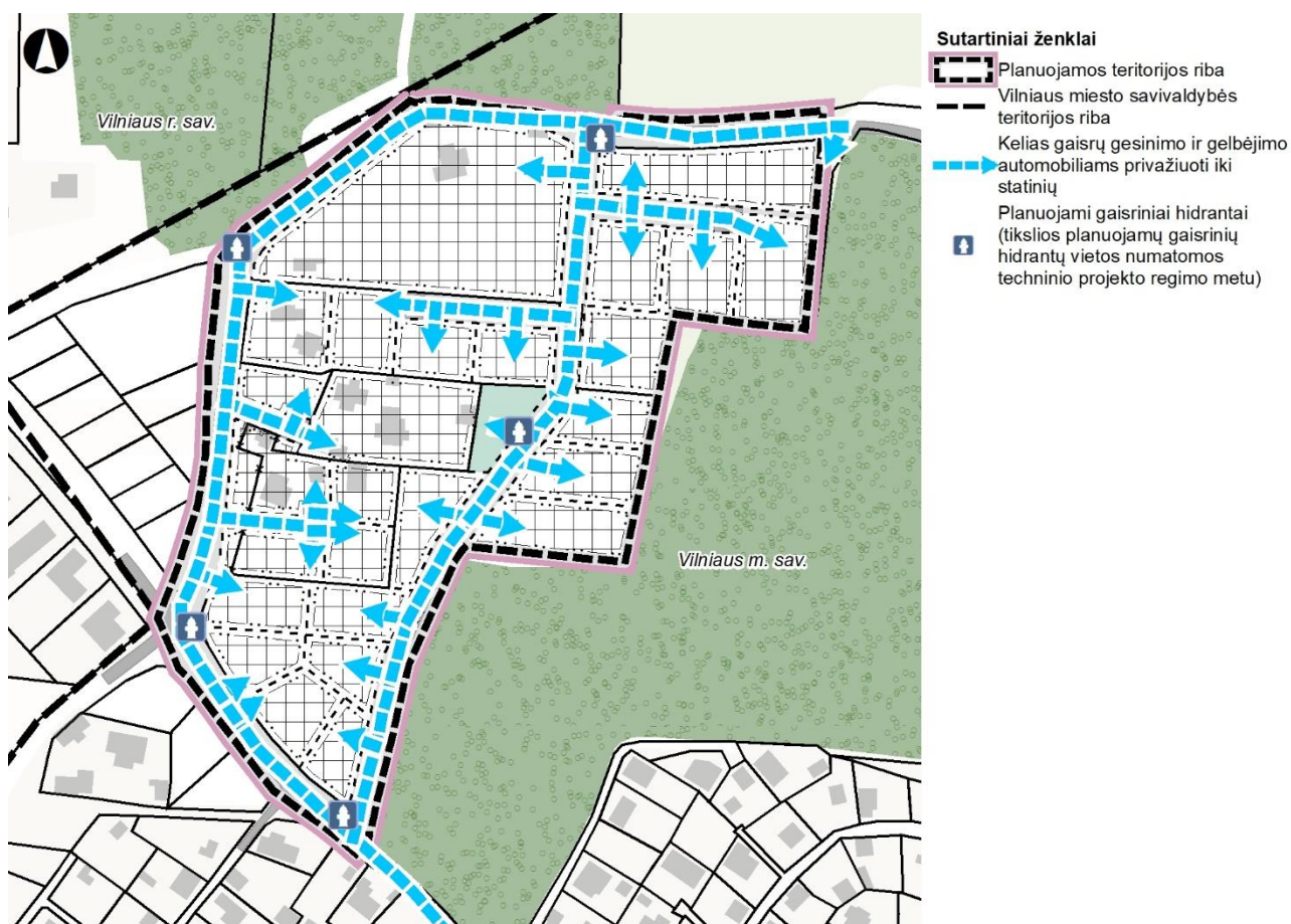
6.3 pav. Gaisro gesinimo ir gelbėjimo automobiliams privažiuoti prie statinių išdėstymo schema
