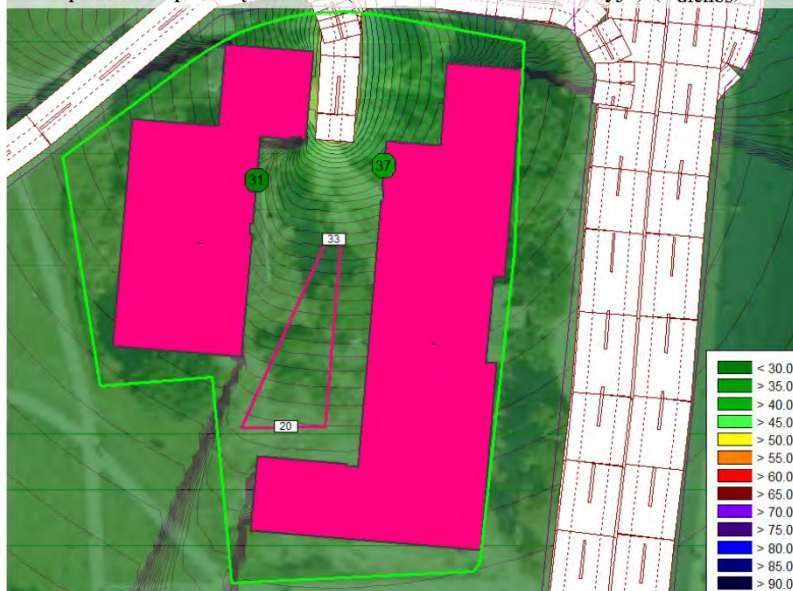
Ekvivalentinis triukšmo lygis dB(A) ties planuojamų gyvenamosios paskirties pastatų fasadais (3-as aukštas 7,5 m aukštyje) ( L_{vakaro} )
